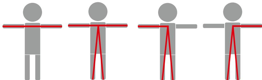
Непосредственными причинами смерти человека, пораженного электрическим током, является прекращение работы сердца, остановка дыхания вследствие паралича мышц грудной клетки и электрический шок. Наиболее неблагоприятный исход поражения человека электрическим током будет в случаях, когда прикосновение произошло влажными руками к электроприборам или электропроводу в сыром или жарком помещении.
